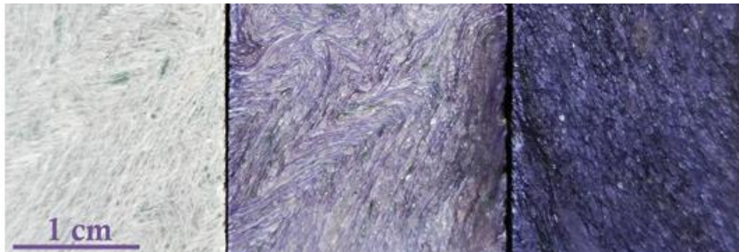
Рисунок 1. Равномерное окрашивание чароитита прямым красителем. Исходный чароитит (слева), два образца чароитита, выдержанные в водном растворе прямого синего СВ-КУ красителя: средней насыщенности (по центру) и чрезмерной насыщенности раствора (справа).
