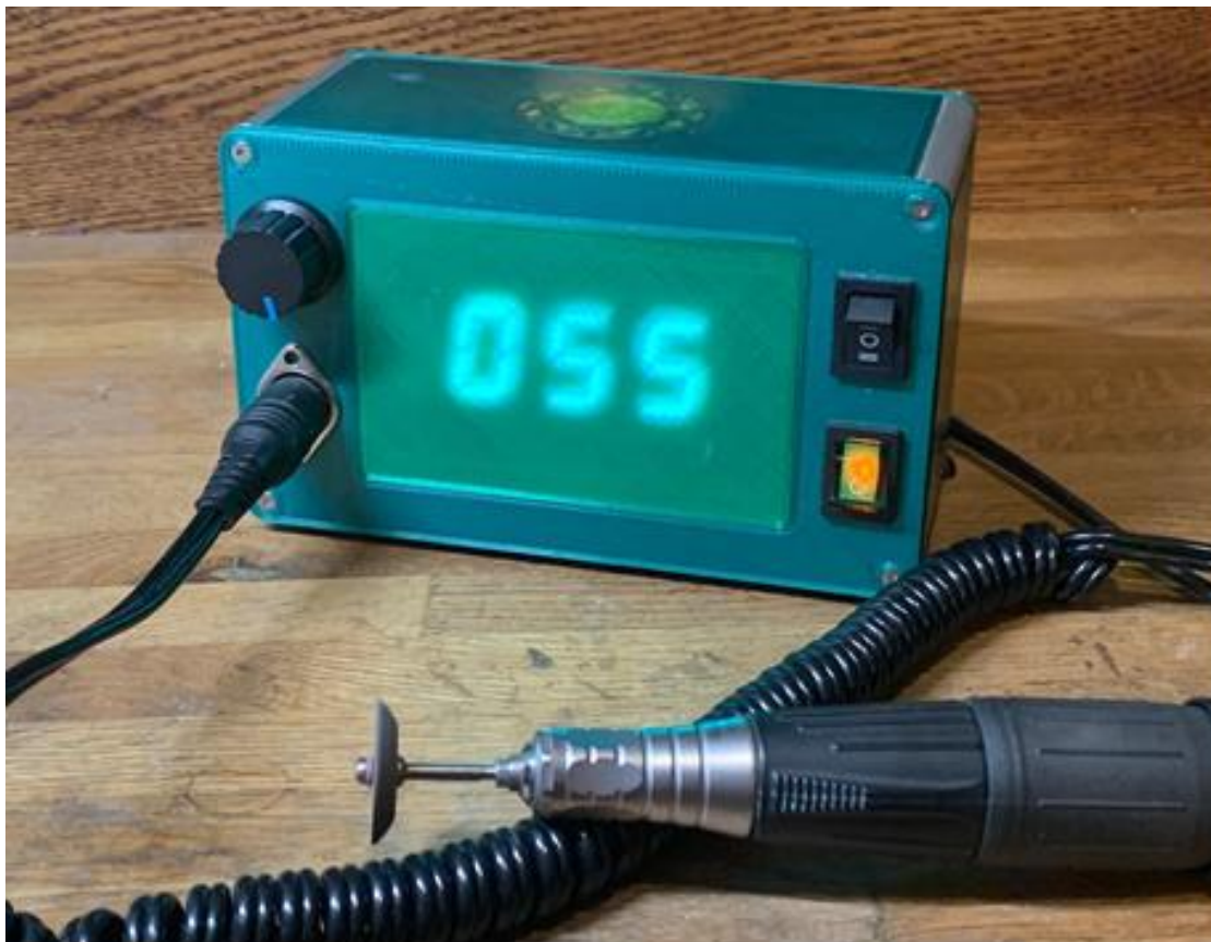
Рисунок 2. Напечатанный корпус блока управления с микродвигателем
