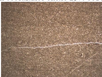
Рисунок 7. Контакт аргиллита с алевритовой примесью. Среднее значение K_{пор} = 7,9\%
