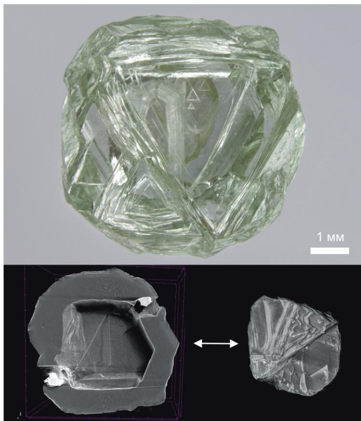
Рисунок 1. Алмаз «Матрешка» (оптическая микроскопия) и совмещение отпечатков индукционной штриховки на внутренней поверхности полости и содержащемся в ней алмазе для восстановления первоначальной позиции алмазного включения выполненное с помощью рентгеновского микротомографа Sky Scan 1272 (Коногорова и др. 2020).
