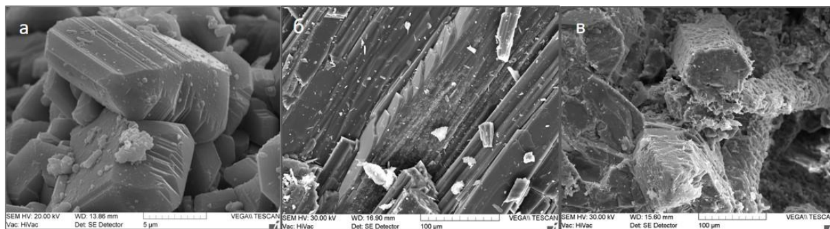
Рисунок 3. Диаспор, Джангалгали – а, диаспор, Алагульское – б, корунд, Алагульское – в. СЭМ.
